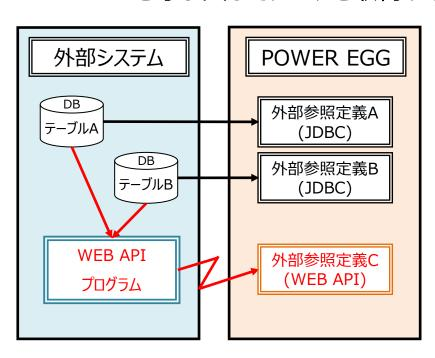
外部システム側のWEB APIを呼び出すことが可能になり、 DB参照コード入力、DB参照項目の用途が拡がります
